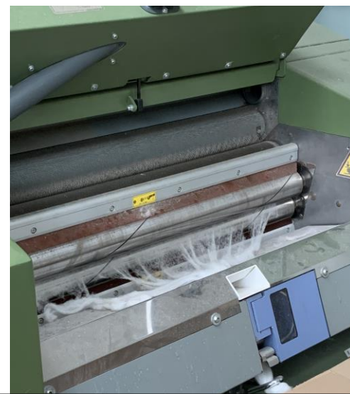
De la balle de coton à la nappe peignée, étirée puis filée obtention du ruban
