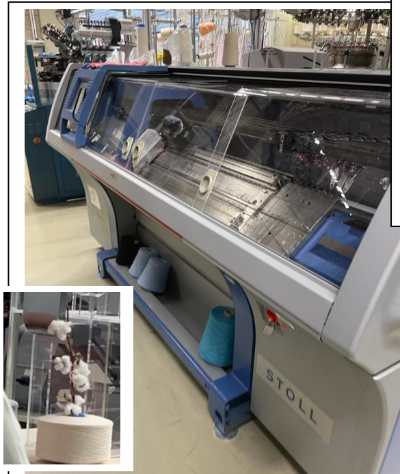
Métiers à tisser automatisés, tubulaire pour la maille ou rectiligne pour maille et rectiligne pour chaîne et trame
