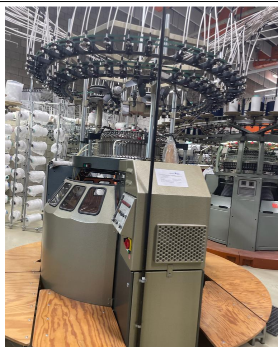
Métiers à tisser automatisés, tubulaire pour la maille ou rectiligne pour maille et rectiligne pour chaîne et trame
